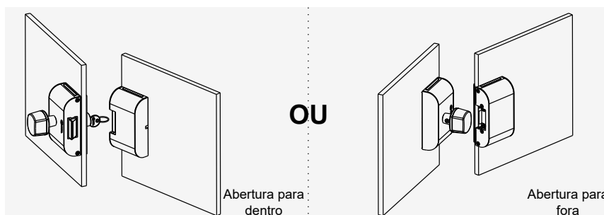
Instalação da parte fixa (de acordo com referência e sentido de abertura).
